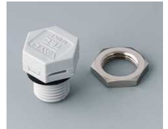
C2310917 Druckausgleichselement M10x1 PA 6 (UL 94 HB) lichtgrau RAL 7035 IP 56
