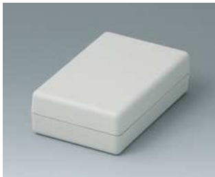
A9406331 SCHALENGEHÄUSE G 110, Ausf. I ABS (UL 94 HB) grauweiß RAL 9002 72x114x33mm IP 65 opt.
