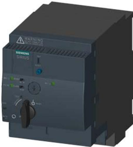
SIRIUS, KOMPAKTABZWEIG, WENDESTARTER 690 V, AC/DC 110 ... 240 V, 50 ... 60 HZ, 0,1 ... 0,4 A, IP20, ANSCHLUSS HAUPTSTROMKREIS: STECKBAR, OHNE KLEMMEN, ANSCHLUSS STEUERSTROMKREIS: STECKBAR, OHNE KLEMMEN
