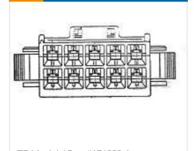
TE Model / Part #176298-1 UNVI POWER CAP HSG 10P PAN MTG
