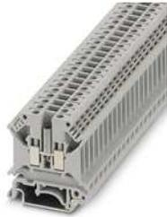
Durchgangsklemme, Nennspannung: 800 V, Nennstrom: 32 A, Anschlussart: Schraubanschluss, Bemessungsquerschnitt: 4 mm<sup>2</sup>, Querschnitt: 0,2 mm<sup>2</sup> - 6 mm<sup>2</sup>, Montageart: NS 35/7,5, NS 35/15, NS 32, Farbe: grau
