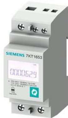
SENTRON, Messgerät, 7KT PAC1600, LCD, L-N: 230 V, 63 A, Hutschienengerät, 1-phasig, S0 + MID, Schein- / Wirk- / Blindenergie, eigenversorgt, Schraubanschluss
