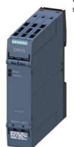
Thermistor-Motorschutzrelais Standard-Auswertegerät 22,5 mm Gehäuse Federzugklemme 2 Wechsler US = AC/DC 24 V Auto-RESET geeignet für Bimetallschalter 2 LEDs (READY/TRIPPED) galvanische Trennung
