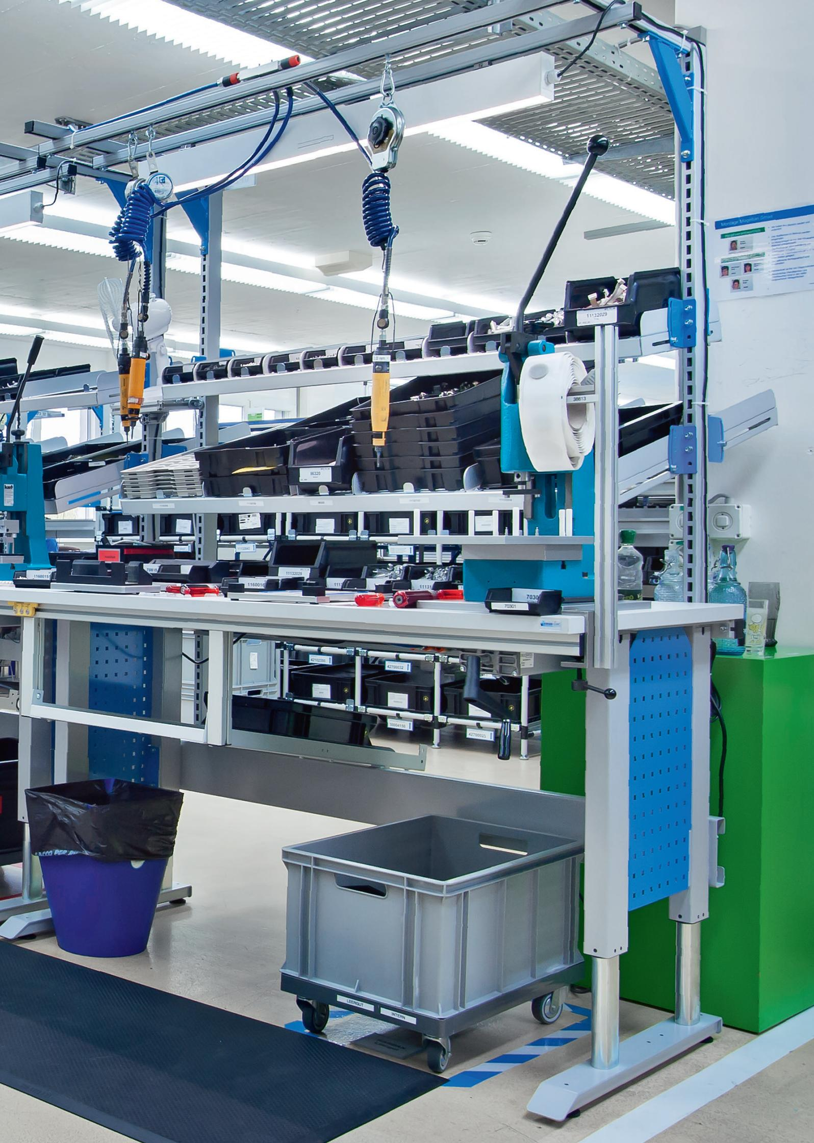
Freistehende Aufbauten bieten eine kostengünstige Alternative zu einem Tisch. Z. B. wenn die Fördertechnik bereits bestehend ist und man einen Packprozess einfach integrieren will. Verschiedene Rasterbreiten sind beliebig kombinierbar.
