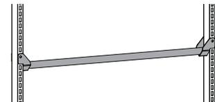
**Achsauflage zwischen Lochprofilen**
