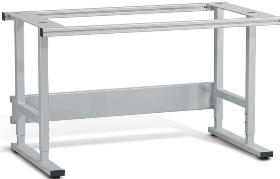
Stabile Konstruktion aus 40 x 40 mm Stahlrohr kombiniert mit einem robusten hinteren C-Profil für die Aufnahme der Aufbauten. Für die obere Aufnahme der Arbeitsplatten sowie die Befestigung der Schubladen werden 40-er Aluprofile verwendet. Qualitativ hochstehende Pulverbeschichtung in RAL 9006 Weissaluminium.
