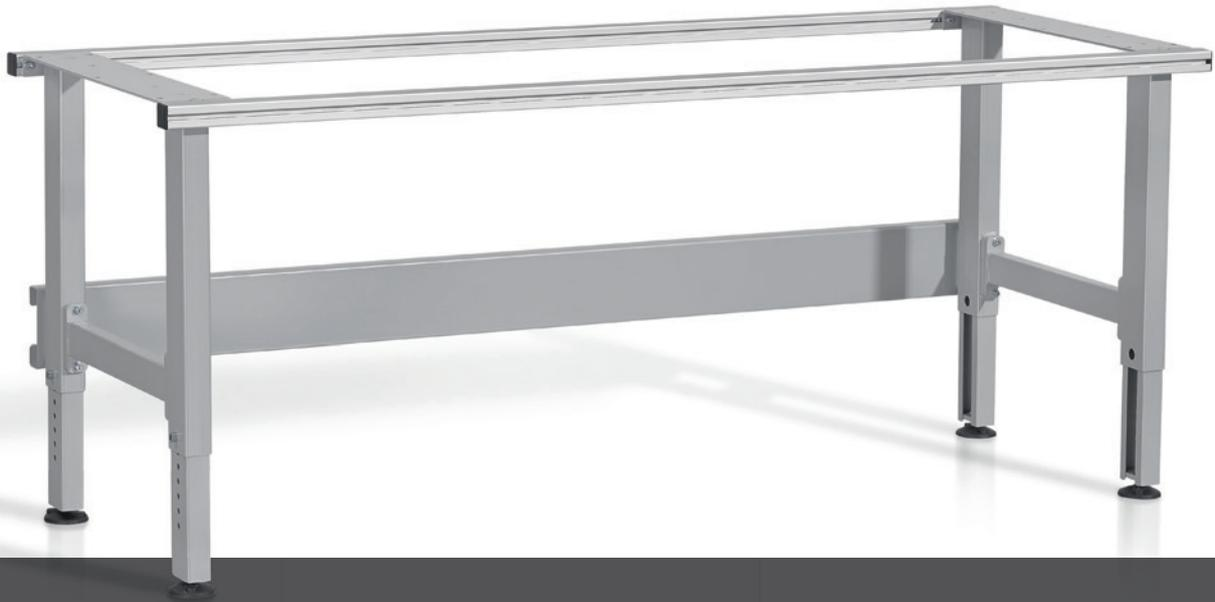
Das ERGO-Forte Grundgestell ist die optimale Lösung für schwere Arbeitsplätze mit einem stabilen Stand. Dank einer hochwertigen Führung ist der Tisch auch in voll ausgefahrener Position sehr robust. Standardmässig ist er mit einem Verstellbereich von 300 mm ausgerüstet. Auf Anfrage kann dieser bis 400 mm erweitert werden.
