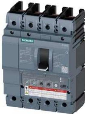
Leistungsschalter 3VA6 UL Frame 250 Schaltvermögenklasse L 150kA @ 480V 4-polig, Anlagenschutz ETU330, LIG, In=100A Überlastschutz Ir=40A...100A Kurzschlusschutz li=1,5...12 x In N-Leiterschutz einstellbar (OFF, 50%, 100%) Erdschlusschutz Ig=0,2...1 x In= tg=0,1/0,3s ohne Anschluss
