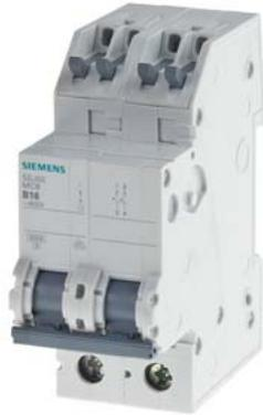
Leitungsschutzschalter 230V 6kA, 1+N-polig, C, 10A, T=70mm mit schraubenlosen Abgangsklemmen
