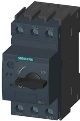
LEISTUNGSSCHALTER BGR. S00, FUER DEN TRAFOSCHUTZ A-AUSL. 1,1...1,6 A, N-AUSL. 33A SCHRAUBANSCHLUSS, STANDARDSCHALTVERMOEGEN
