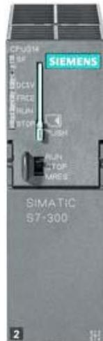
SIMATIC S7-300, CPU 314 ZENTRALBAUGRUPPE MIT MPI, INTEGR. STROMVERSORGUNG DC 24V, ARBEITSSPEICHER 128 KBYTE, MICRO MEMORY CARD ERFORDERLICH
