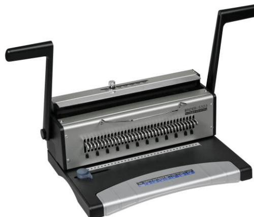
Einsteiger-Drahtbindegerät mit 2-Hebel-Bedienung, und platzsparendem Desktop-Design für Heimanwender. **S303** - verarbeitet aus robustem Metall ist ausgestattet mit einem großen Stanzabfallbehälter, zwei zur Auswahl stehenden Drahtbinderückenhaltern, eine einstellbare Stanztiefe und einen seitlichen Stanzanschlag.
