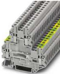
Schutzleiter-Doppelstockklemme, Nennspannung: 500 V, Nennstrom: 24 A, Anschlussart: Schraubanschluss, Bemessungsquerschnitt: 2,5 mm<sup>2</sup>, Querschnitt: 0,14 mm<sup>2</sup> - 4 mm<sup>2</sup>, Montageart: NS 35/7,5, NS 35/15, Farbe: grau
