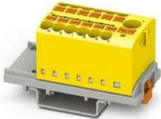
Verteilerblock, die Blöcke sind untereinander über den Leiterschacht brückbar, passende Steckbrücken siehe Zubehör, Block mit senkrechter Ausrichtung und integrierter Einspeisung, Nennspannung: 690 V, Nennstrom: 24 A, Anschlussart: Push-in-Anschluss, Abgriff, Querschnitt: 0,14 mm<sup>2</sup> - 4 mm<sup>2</sup>, Push-in-Anschluss, Sammelaanschluss, Bemessungsquerschnitt: 6 mm<sup>2</sup>, Querschnitt: 0,5 mm<sup>2</sup> - 10 mm<sup>2</sup>, Montageart: NS 35/7,5, NS 35/15, Farbe: gelb
