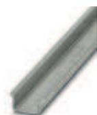
Tragschiene, Material: Stahl, ungelocht, 2,3 mm dick, Höhe 15 mm, Breite 35 mm, Länge: 2 m
