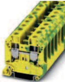
Schutzleiter-Reihenklemme, Anschlussart: Schraubanschluss, Querschnitt: 1,5 mm<sup>2</sup> - 25 mm<sup>2</sup>, AWG: 16 - 4, Breite: 12,2 mm, Höhe: 54,4 mm, Farbe: grün-gelb, Montageart: NS 35/7,5, NS 35/15
