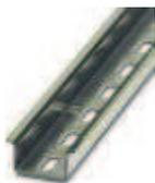
Tragschiene, Material: Stahl verzinkt und dickschichtpassiviert, gelocht, Höhe 15 mm, Breite 35 mm, Länge: 2000 mm
