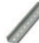
Tragschiene, Material: Stahl verzinkt und dickschichtpassiviert, gelocht, Höhe 7,5 mm, Breite 35 mm, Länge: 2000 mm
