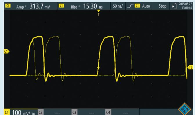
Das High-Speed-Erfassungssystem des R&S®ScopeRider erfasst bis zu 50 000 Messkurven pro Sekunde und deckt seltene und unerwartete Signalanomalien auf.
