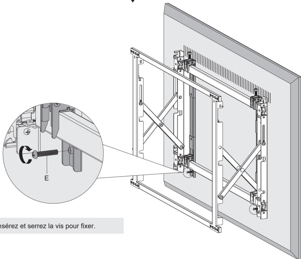
Insérez et serrez la vis pour fixer.
