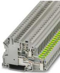
Bauelementreihenklemme, mit Prüfbuchsen-schrauben zur Aufnahme von Prüfsteckern, Nennspannung: 500 V, Nennstrom: 0,5 A, Anschlussart: Schraubanschluss, Bemessungsquerschnitt: 4 mm<sup>2</sup>, Querschnitt: 0,14 mm<sup>2</sup> - 6 mm<sup>2</sup>, Montageart: NS 35/7,5, NS 35/15, Farbe: grau
