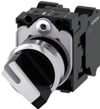
Knebelschalter, beleuchtbar, 22 mm, rund, Metall, hochglanz, weiß, Knebel, kurz, 2 Schaltstellungen O-I, verrastend, Schaltwinkel 90°, 10:30h/13:30h, mit Halter, 1S, 1Ö, Federzuganschluss
