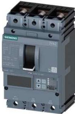
Leistungsschalter 3VA2 IEC Frame 250 Schaltvermögenklasse L Icu=150kA @ 415V 3-polig, Anlagenschutz ETU550, LSI, In=160A Überlastschutz Ir=63A...160A Kurzschlusschutz Isd=0,6..10x In, li=1,5..12x In N-Leiterschutz optional mit externem Stromwandler, bis 160% Schraubenflachanschluss
