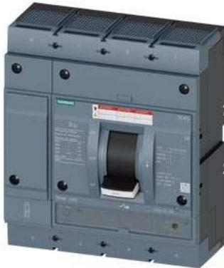
Leistungsschalter 3VA5 UL Frame 800 Schaltvermögenklasse H 65kA @ 480 V 4-polig, Anlagenschutz TM230, FTAM, In=600A Überlastschutz, 100%-rated Ir=600A fest eingestellt Kurzschlusschutz Ii=5...10 x In N-Leiter 1 beidseitig Kabelanschluss
