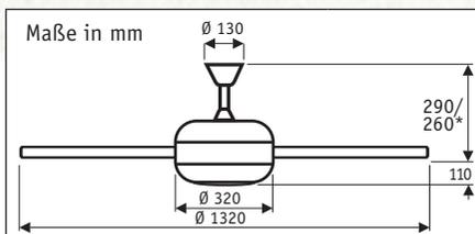
\* Maß bei Montage mit gekürzter Deckenstange
