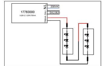
LED-Konverter 700 mA, DALI dimmbar, (digital). Dieser Konverter ist durch Sicherungseinrichtungen gegen Überspannung und Kurzschluss sowie thermische und elektrische Überlastung geschützt. Die Eingangs- und die Ausgangsklemme ist für Leitungen mit einem Querschnitt von 0,75-1,5 mm<sup>2</sup> geeignet. Material: Kunststoff, Schutzart: nach DIN EN 60529: IP20, Schutzklasse: (EN 61140) II, Strom: 700 mA, Spannung: 230V AC 50Hz, Leistung: 2,1-20W, Art der Dimmung: DALI-2, nicht abwärtskompatibel.
