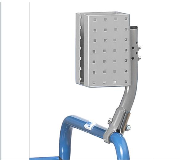
Scannerhalter aus Stahlblech, pulverbeschichtet lichtgrau RAL 7035. Rohrstrebe vielfach gelocht, mit einer Klemmschelle zur Befestigung der Scannertasche an fast allen fetra-Produkten in fast allen Positionen. Scanneraufnahme B x T x H: 120 x 87 x 150 mm, Vordere Öffnung: 40 mm breit
