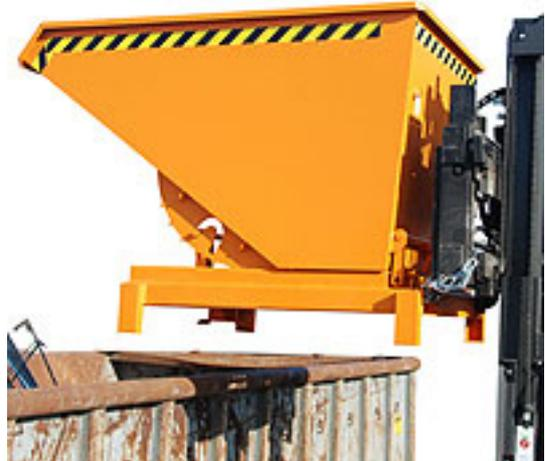
Abrutschen und Auskippen. Lackiert oder feuerverzinkt nach EN ISO 146. Tragkraft: 4000 kg. Orange (RAL 2000) Rot (RAL 3000) Blau (RAL 5012) Grün (RAL 6011) Grau (RAL 7005) Feuerverzinkt (EN ISO 1461) Typ SK 2100 Muldeninhalt: 2,10 m<sup>3</sup> Maße: L 1720 x B 1870 x H 1240 mm Gewicht: 480 kg (lackiert), 514 kg (verzinkt)
