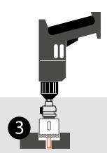
Platzieren Sie den DryXcut-Zentrierbohrer im vorgebohrten Loch. Jetzt bohren Sie präzise und sicher.
