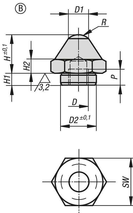
**Auflagebolzen mit Positionierzapfen, Form B Kugelfläche****Artikelübersicht**
