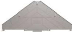
Eine Trennwand wird zur optischen Trennung von Stromkreisen oder zur elektrischen Trennung bei benachbarten Querverbindungen genutzt. Die Kontur kann im Gegensatz zur Abschlussplatte größer als die benachbarten Reihenklemmen sein. Kleiner sollte Sie jedoch nicht sein, da ansonsten die geforderten Luft- und Kriechstrecken innerhalb der Applikation nicht mehr eingehalten werden.
