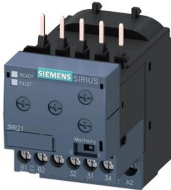
Überwachungsrelais, anbaubar an Schütz 3RT2, Baugröße S00 Basic, analog einstellbar Scheinstromüberwachung 1,6-16 A, 20-400 Hz, 2-phasig Versorgung 24 V AC/DC 1 Wechsler Überwachung auf Stromüber- und Unterschreitung Phasenausfall, Drahtbruch mit oder ohne Fehlerspeicher Anlaufverzögerung 0-60 s Störspitzenausblendung 0-30 s Schalthysterese 6% Schraubanschlusstechnik
