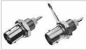
HF-Schnittstelle: **BNC**HF-SteckverbinderAusführung: **Klinke**HF-Steckverbinder Außendurchmesser gesteckt (ca.): **14.53 mm [ .572 in ]**Impedanz: **50 Ω**HF-Steckverbinder-Kupplungsmechanismus: **Bajonett**
