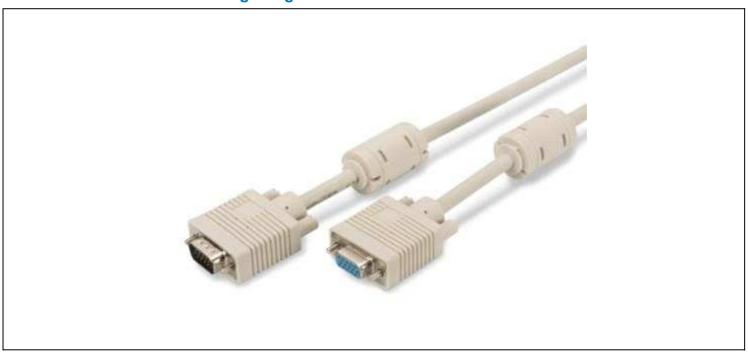
VGA Monitor Verlängerungskabel, HD15 St/Bu, 5.0m, 3Coax/7C, 2xFerrit, be
