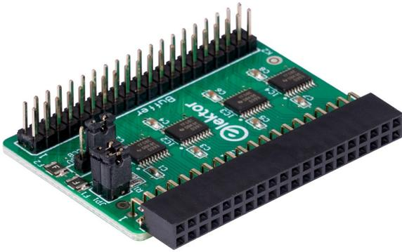
Diese Logiklevelwandlerplatine ermöglicht es Geräte mit einem Logiklevel von 5 V an der 40-poligen GPIO-Stiftleiste des Raspberry Pis zu betreiben. Das Logiklevel der GPIOs kann mit einem Jumper zwischen 3,3 V und 5 V umgestellt werden.
