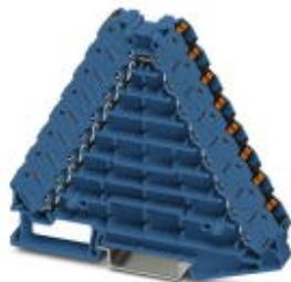
Potenzialverteiler, Nennspannung: 250 V, Nennstrom: 17,5 A, Querschnitt: 0,14 mm<sup>2</sup> - 2,5 mm<sup>2</sup>, AWG: 14 - 26, Anschlussart: Push-in-Anschluss, Breite: 8,3 mm, Länge: 100 mm, Farbe: blau, Montage: NS 35/7,5, NS 35/15
