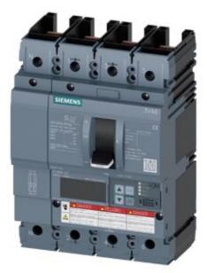
Leistungsschalter 3VA6 UL Frame 250 Schaltvermögenklasse M 35kA @ 480V 4-polig, Anlagenschutz ETU830, LIG, In=100A Überlastschutz Ir=40A...100A Kurzschlussschutz Ii=1,5...12 x In Erdschlussschutz Ig=0,2...1 x In, tg=0,05-0,8s ohne Anschluss
