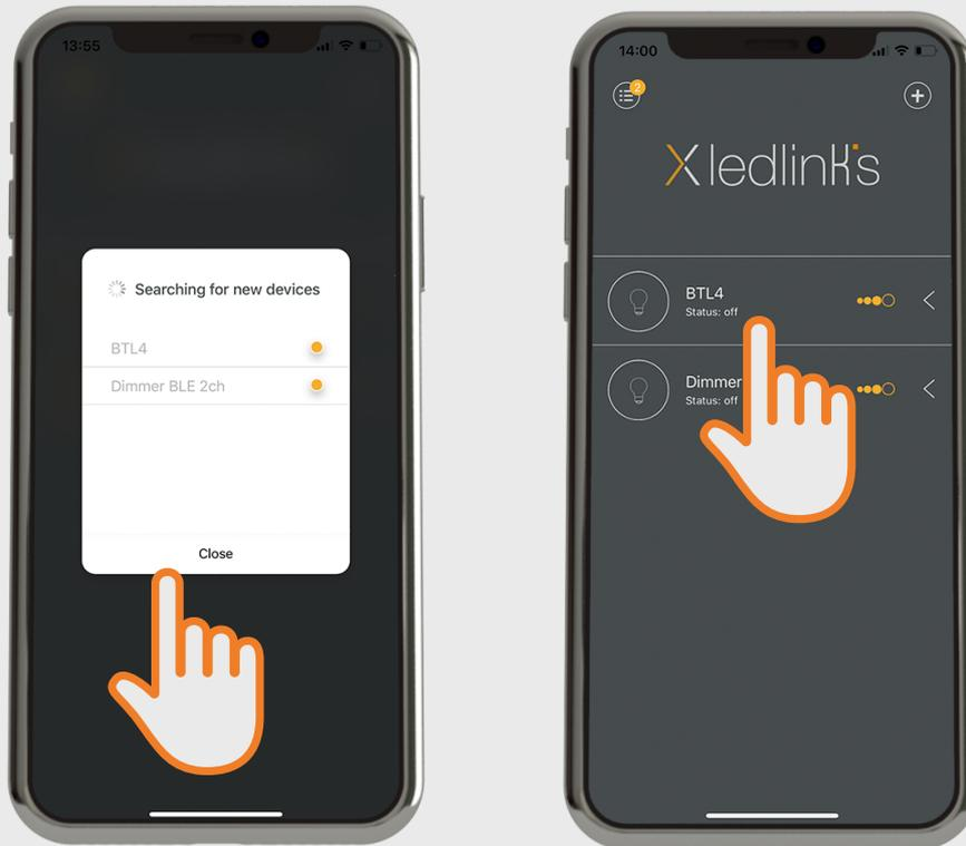
Nachdem das zu koppelnde Gerät markiert und ggf. das Firmware-Update durchgeführt wurde, schließen Sie bitte das Fenster mit einem Klick auf „Close“.
