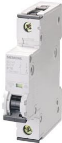
LEITUNGSSCHUTZSCHALTER 230/400V 10KA, 1-POLIG, D, 6A, T=70MM
