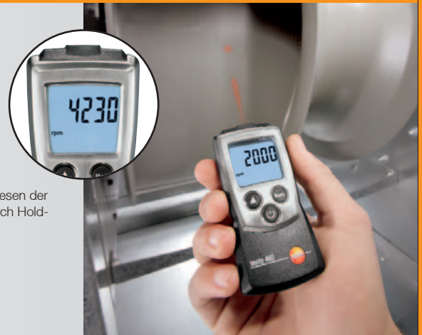
Berührungslose Drehzahlmessung an einem Ventilator
