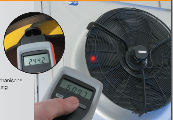
testo 465 und testo 470, berührungslose (optische) Drehzahl-Messung an rotierenden Teilen
