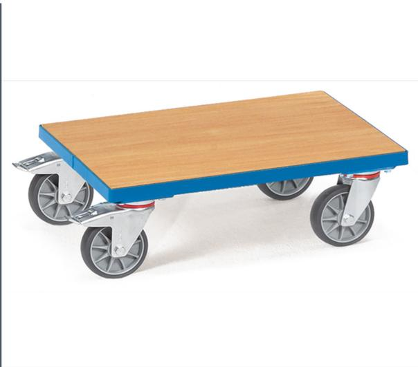
Eurokasten-Roller in Winkelstahlkonstruktion mit Boden aus Holzwerkstoffplatte, bündig im Rahmen liegend. Pulverbeschichtet blau RAL 5007. 4 Lenkrollen mit TPE-Bereifung, Naben mit Rillenkugellager. 2 Stück mit Feststeller, gemäß der Europäischen Norm EN 1757-3 (Sicherheit von Plattformwagen). Passend für Eurokästen 600 x 400 mm.
