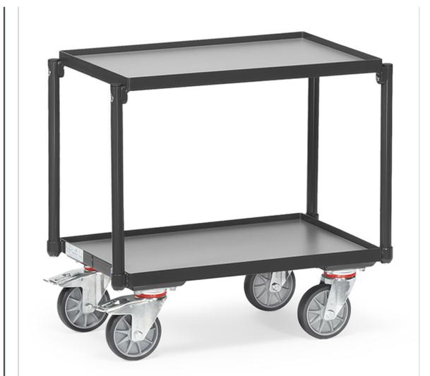
Construction en profilé d'acier, revêtement époxy gris anthracite RAL 7016. 2 plateaux en mélaminé surface gris moyen avec rebord de 15 mm, distance entre les plateaux : 400 mm. Hauteur totale : 630 mm. 4 roues pivotantes à bandage TPE, moyeu à roulement à billes central. 2 roues avec freins conformément à la Norme EN 1757-3. Compatibles pour bacs plastiques 600 x 400 mm.
