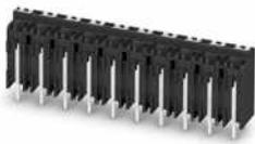
Leiterplattenklemme, Nennstrom: 13,5 A, Bemessungsspannung (III/2): 320 V, Nennquerschnitt: 1,5 mm<sup>2</sup>, Anzahl der Potenziale: 6, Anzahl der Reihen: 1, Polzahl pro Reihe: 6, Artikelfamilie: SPT 1,5/..-V-THR, Rastermaß: 5 mm, Anschlussart: Push-in-Federanschluss, Montage: THR-Löten, Anschlussrichtung Leiter/Platine: 90 °, Farbe: schwarz, Pin-Layout: Lineares Pinning, Pinlänge [P]: 2 mm, Anzahl der Lötpins pro Potenzial: 2, Verpackungsart: Gurt in 56 mm Breite
