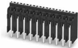
Leiterplattenklemme, Nennstrom: 13,5 A, Bemessungsspannung (III/2): 160 V, Nennquerschnitt: 1,5 mm<sup>2</sup>, Anzahl der Potenziale: 8, Anzahl der Reihen: 1, Polzahl pro Reihe: 8, Artikelfamilie: SPT 1,5/-V-THR, Rastermaß: 3,5 mm, Anschlussart: Push-in-Federanschluss, Montage: THR-Löten, Anschlussrichtung Leiter/Platine: 90 °, Farbe: schwarz, Pin-Layout: Lineares Pinning, Pinlänge [P]: 2 mm, Anzahl der Lötpins pro Potenzial: 2, Verpackungsart: Gurt in 72 mm Breite
