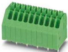
Leiterplattenklemme, Nennstrom: 2 A, Bemessungsspannung (III/2): 250 V, Nennquerschnitt: 0,5 mm<sup>2</sup>, Anzahl der Potenziale: 11, Anzahl der Reihen: 1, Polzahl pro Reihe: 11, Artikelfamilie: PTSA 0,5, Rastermaß: 2,5 mm, Anschlussart: Push-in-Federanschluss, Montage: Wellenlöten, Anschlussrichtung Leiter/Platine: 45 °, Farbe: grün, Pin-Layout: Zick-Zack-Pinning M, Pinlänge [P]: 3,6 mm, Anzahl der Lötpins pro Potenzial: 1, Verpackungsart: verpackt im Karton. Versetze Lötbeine, zweireihig
