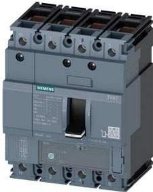
Leistungsschalter 3VA1 IEC Frame 160 Schaltvermögenklasse S Icu=36kA @ 415V 4-polig, Anlagenschutz TM220, ATFM, In=32A Überlastschutz Ir=22A...32A Kurzschlusschutz Ii=10 x In N-Leiter ungeschützt Klemmenanschluss
