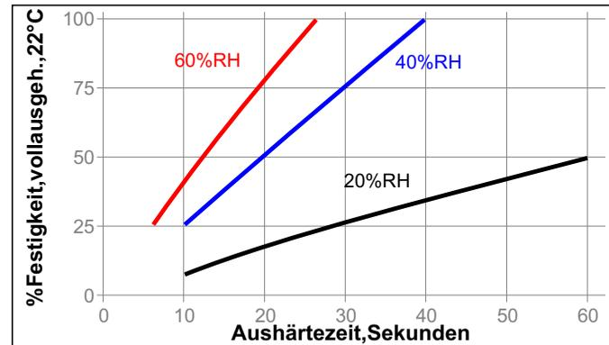
**Aushärtegeschwindigkeit in Abhängigkeit vom Aktivator**
