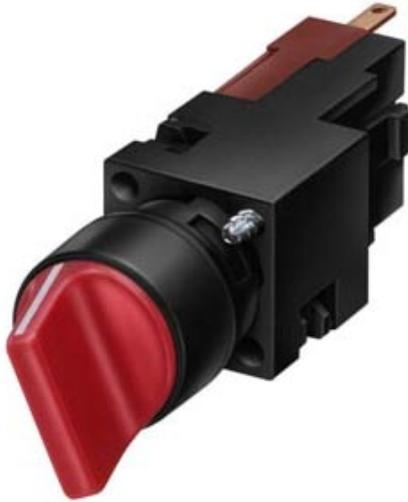
KNEBELSCHALTER, 16MM, RUND, KUNSTSTOFF, ROT, 2 SCHALTSTELLUNGEN O-I, VERRASTEND, SCHALTWINKEL 62GRAD 1S
