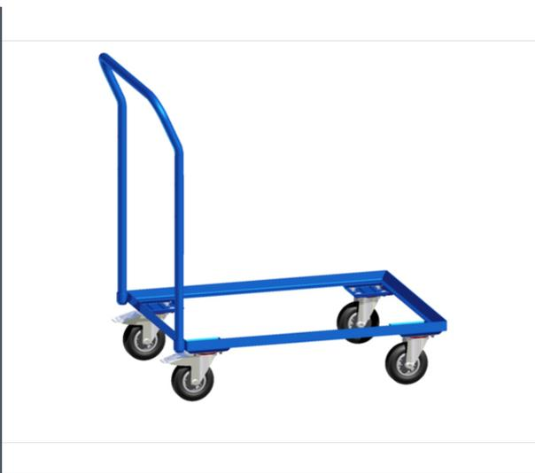
Offene Winkelstahlkonstruktion mit Rohrschiebebügel, pulverbeschichtet blau RAL 5007. 4 Lenkrollen mit TPE-Bereifung, Naben mit Rillenkugellager. 2 Stück mit Feststeller, gemäß der Europäischen Norm EN 1757-3 (Sicherheit von Plattformwagen). Passend für Eurokästen 600 x 400 mm.
