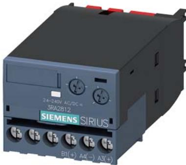
Elektronisches Zeitrelais, rückfallverzögert, mit Steuersignal und Halbleiterausgang, Zeitbereich 0,05-100 s, AC/DC 24-240 V, 50/60 Hz, Varistor zur Bedämpfung der Schützspulen integriert, Schraubanschluss, frontseitig aufschraubbar auf Schütze 3RT2.1 / 3RT2.2 und Hilfsschütze 3RH2
