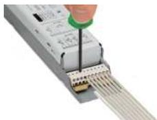
Leiter mittels Lösewerkzeug (Ø 1,0 mm, 206-841) lösen.
