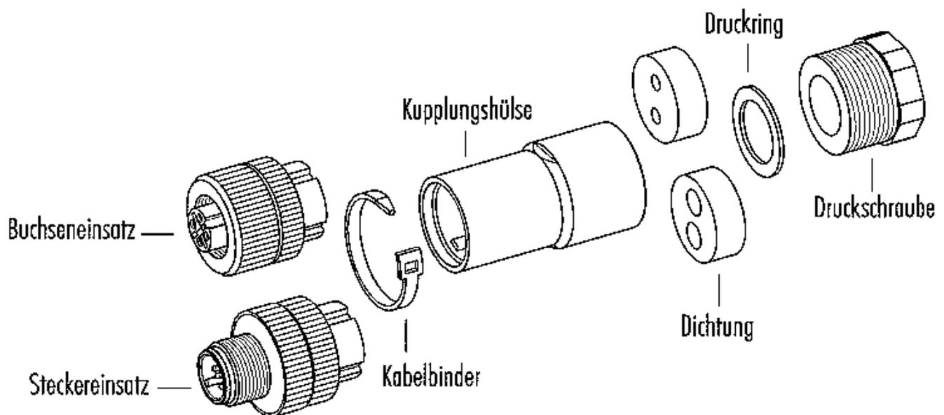
Material der Gewinderinge: Kunststoff, Zink Druckguss, Edelstahl
