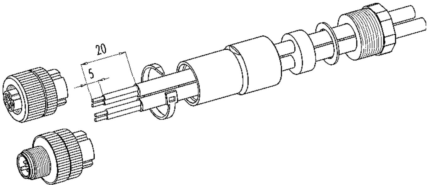
Material der Gewinderinge: Kunststoff, Zink Druckguss, Edelstahl
