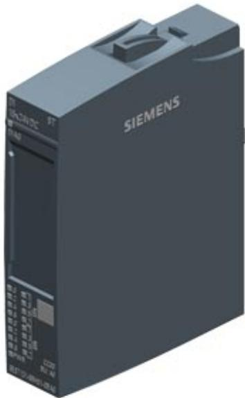
SIMATIC ET 200SP, Digitales Eingangsmodul, DI 16x 24V DC Standard, Eingangstyp 3 (IEC 61131), Sink Input, (PNP, P-lesend), Verpackungseinheit: 10 Stück, passend für BU-Typ A0, Farbcode CC00, Eingangsverzögerung 0,05..20ms; Modul-Diagnose für: Drahtbruch, Versorgungsspannung
