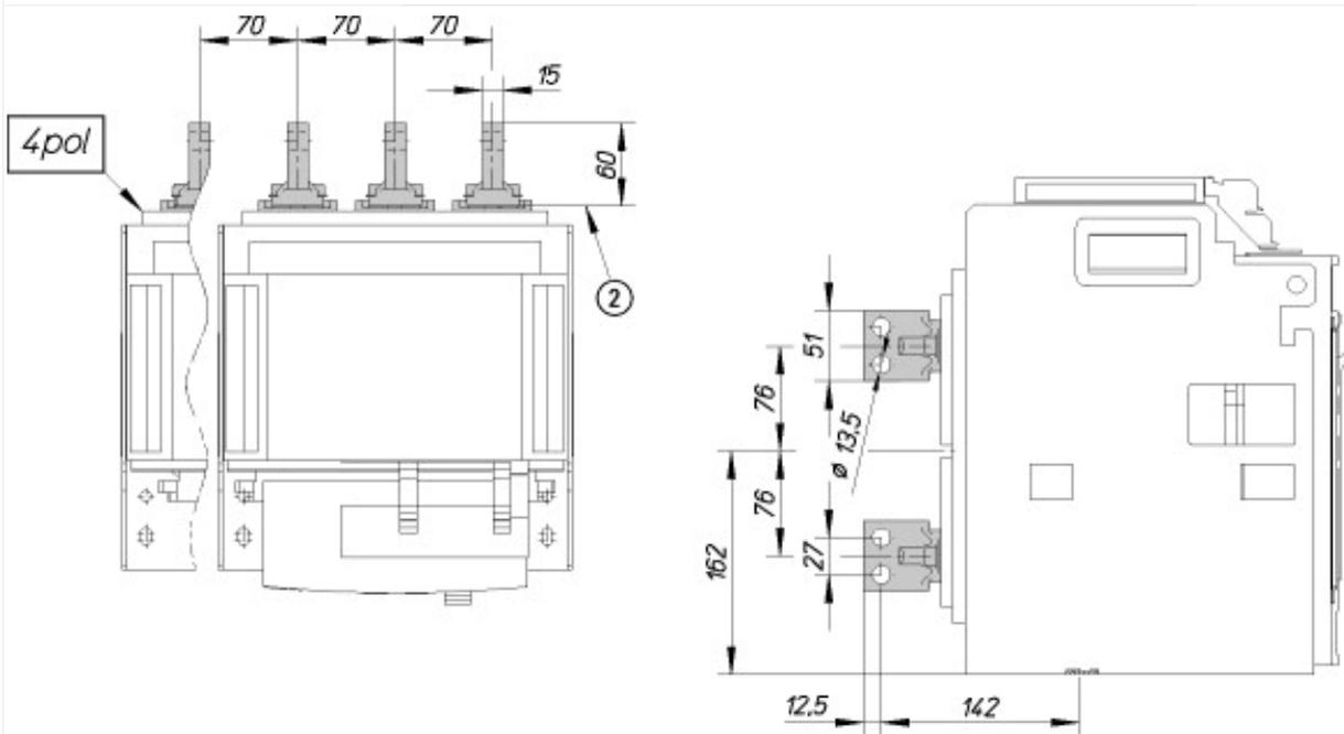
② Kontaktoberfläche Flanschanschluss
